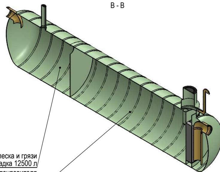
Камера для улавливания песка и грязи
